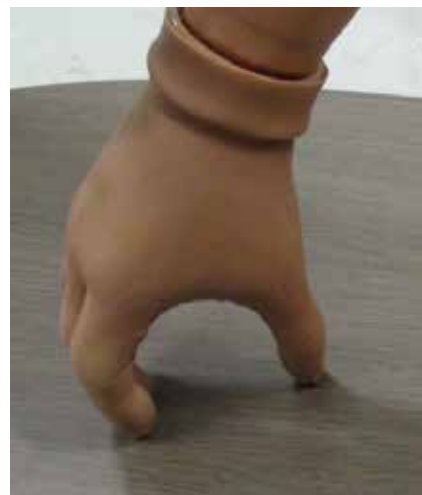
商品として臨床利用されている筋電義手:指形状が固定されているため3点で抑えることとなる
