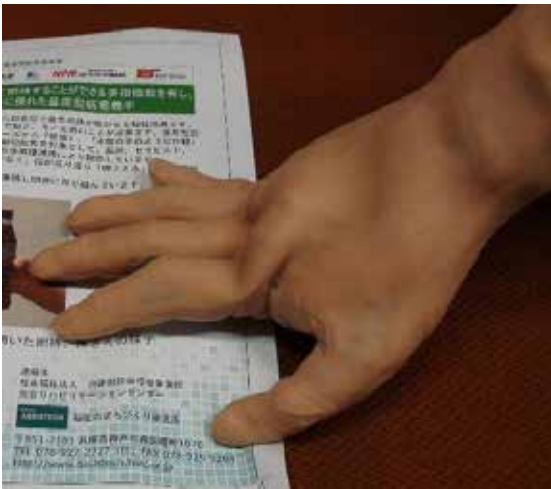
本事業で開発している筋電義手:指が柔軟に反り返り、指の腹で押さえることができる
